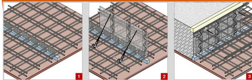
Les Stremafix s'utilisent en principe à partir d'une hauteur de béton 1.0 mètres. Il sert principalement d'étaie pour le Stremaform Strong
